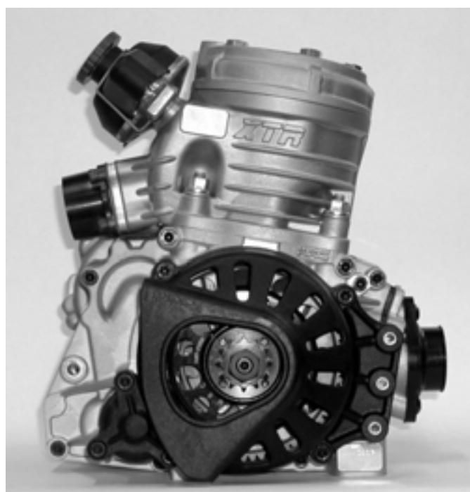
PHOTO DU MOTEUR CÔTÉ PIGNON PHOTO OF DRIVE SIDE OF ENGINE
